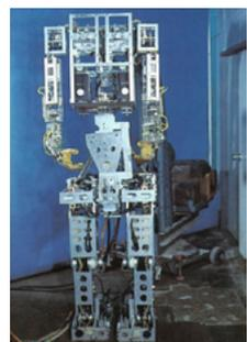
Fig. 8. Wabot-1, robot humanoïde, avec des bras et des jambes, qui peut déplacer des objets avec ses « mains ».
